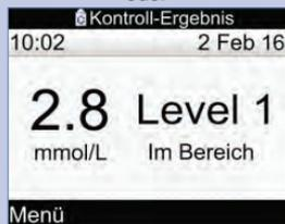
„Im Bereich“ bedeutet, dass der Messwert der Funktionskontrolle innerhalb des zulässigen Bereichs liegt.
