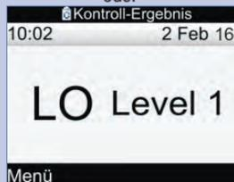
Diese Displays bedeuten, dass das Kontroll-Ergebnis möglicherweise oberhalb („HI“) oder unterhalb („LO“) des Messintervalls für das Messgerät liegt.
