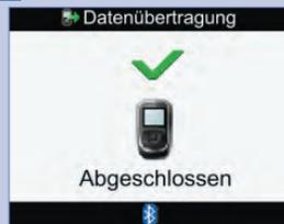
Wenn die Datenübertragung beendet ist, öffnet sich für 3 Sekunden das Display „Datenübertragung – Abgeschlossen“. Anschließend schaltet sich das Messgerät ab.
