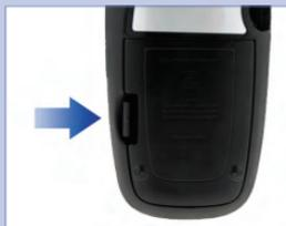
Öffnen und entfernen Sie die Batteriefachabdeckung an der Rückseite des Messgeräts, indem Sie den Riegel in Pfeilrichtung drücken und die Abdeckung nach oben ziehen.
