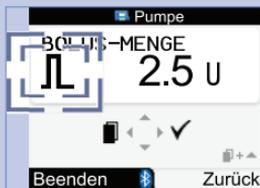
**Standard-Bolus und Multiwave-Bolus:** Das Bolussymbol blinkt 5 Sekunden lang. Innerhalb dieser Verzögerung können Sie durch Betätigung der Taste  $\blacktriangle$  oder  $\blacktriangledown$  verhindern, dass die Pumpe mit der Bolusabgabe beginnt. Wenn keine Aktion erfolgt, gibt das Messgerät 3 Signaltöne und ein Vibrationssignal aus und die Pumpe beginnt mit der Bolusabgabe.
