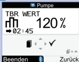
Drücken Sie  $\triangle$  oder  $\nabla$ , um den TBR-Prozentwert zu erhöhen bzw. zu verringern.
