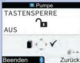
Der aktuelle Status der Tastensperre (EIN oder AUS) wird angezeigt.
