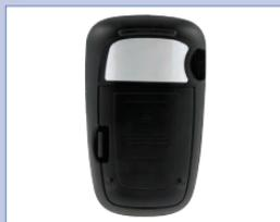
Setzen Sie die Batteriefachabdeckung wieder auf und lassen Sie sie einrasten.
