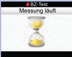
Wenn ausreichend Kontrolllösung im Teststreifen vorhanden ist, wird das Display „Messung läuft“ angezeigt.
