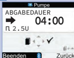
Drücken Sie  $\triangle$  oder  $\nabla$ , um die Dauer zu erhöhen bzw. zu verringern. Die Dauer der Bolusabgabe kann für einen Zeitraum von bis zu 12 Stunden in Schritten zu je 15 Minuten programmiert werden.
