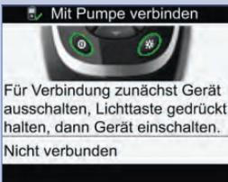
Wenn Messgerät und Pumpe miteinander verbunden sind, wird das Display „Einstellungen erfolgreich abgeschlossen“ angezeigt.
