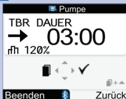
Drücken Sie  $\triangle$  oder  $\nabla$ , um die TBR-Dauer zu erhöhen bzw. zu verringern.
