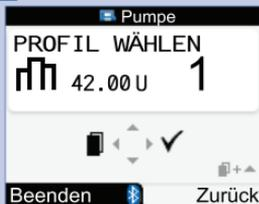
Drücken Sie  $\triangle$  oder  $\nabla$ , um ein Basalratenprofil auszuwählen. Die Nummer des Basalratenprofils und die zugehörige Insulin-Tagesgesamtmenge werden angezeigt.
