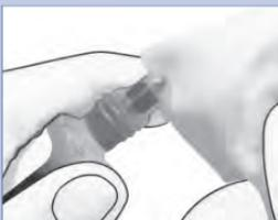
Entfernen Sie den Schraubverschluss von der Flasche mit Kontrolllösung. Wischen Sie die Flaschenspitze mit einem Papiertaschentuch ab. Drücken Sie die Flasche zusammen, bis sich an der Flaschenspitze ein kleiner Tropfen bildet.
