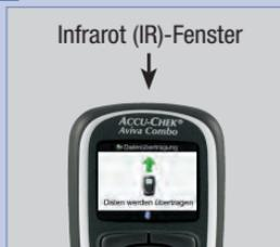
Suchen Sie das Infrarot (IR)-Fenster oben am Messgerät.
