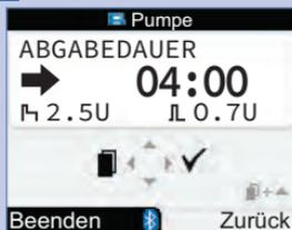
Drücken Sie  $\triangle$  oder  $\nabla$ , um die Dauer des verzögerten Bolus zu erhöhen bzw. zu verringern. Die Dauer der Bolusabgabe kann für einen Zeitraum von bis zu 12 Stunden in Schritten zu je 15 Minuten programmiert werden.
