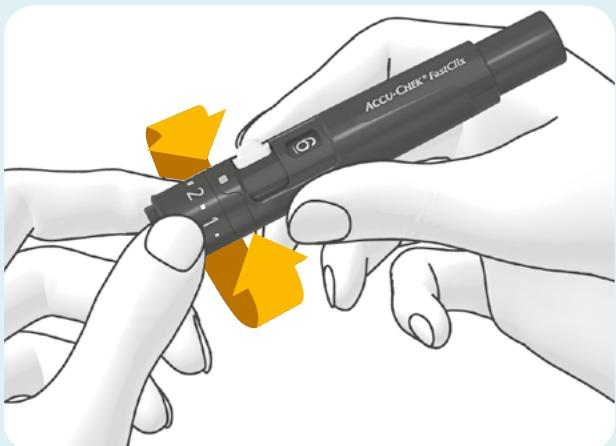
Поверните колпачок так, чтобы отметка указывала нужную глубину прокалывания.
