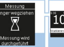
Berühren Sie mit der **gelben Blutauftragsfläche** des Teststreifens den Blutstropfen. Nehmen Sie Ihren Finger vom Teststreifen weg, sobald **Messung wird durchgeführt** auf dem Display erscheint. Tragen Sie das Blut nicht auf die Oberseite des Teststreifens auf.
